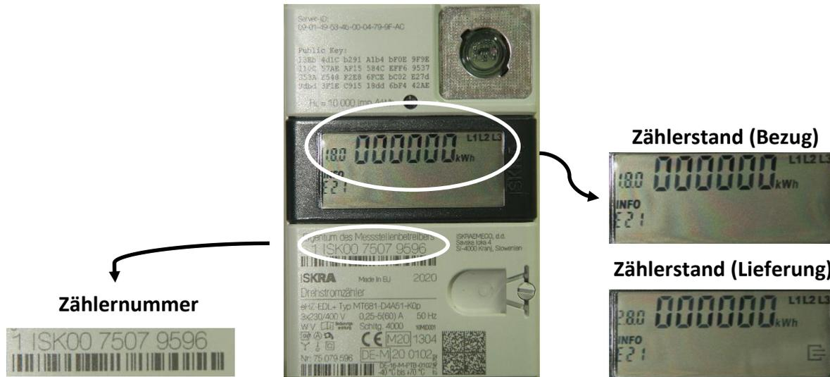
Bei einem digitalen Stromzähler finden Sie die Zählernummer abgedruckt auf der Front des Zählers. Bitte geben Sie die Zählernummer genauso an, wie sie auf dem Zähler verzeichnet ist (es sind, wenn vorhanden, Zahlen und Buchstaben anzugeben).
