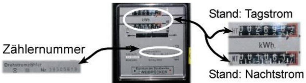
Bei einem konventionellen Stromzähler finden Sie die Zählnummer abgedruckt auf der Front des Zählers. Bitte geben Sie die Zählnummer genauso an, wie sie auf dem Zähler verzeichnet ist.
